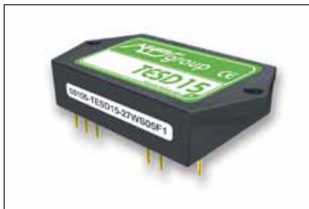
Рис. 2. Модуль TESD15 с треугольными фланцами
