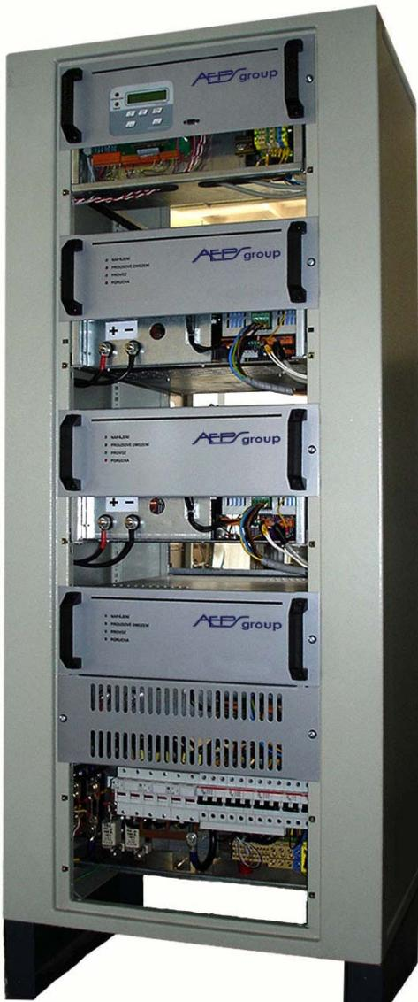
**Цифровой блок управления** размещен в верхней части стойки. Он предназначен для оперативного и дистанционного управления выходными модулями, контроля состояния оборудования и коммуникации с удаленным компьютером.
