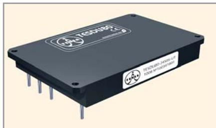
Рис. 4. Преобразователь TESDU80
