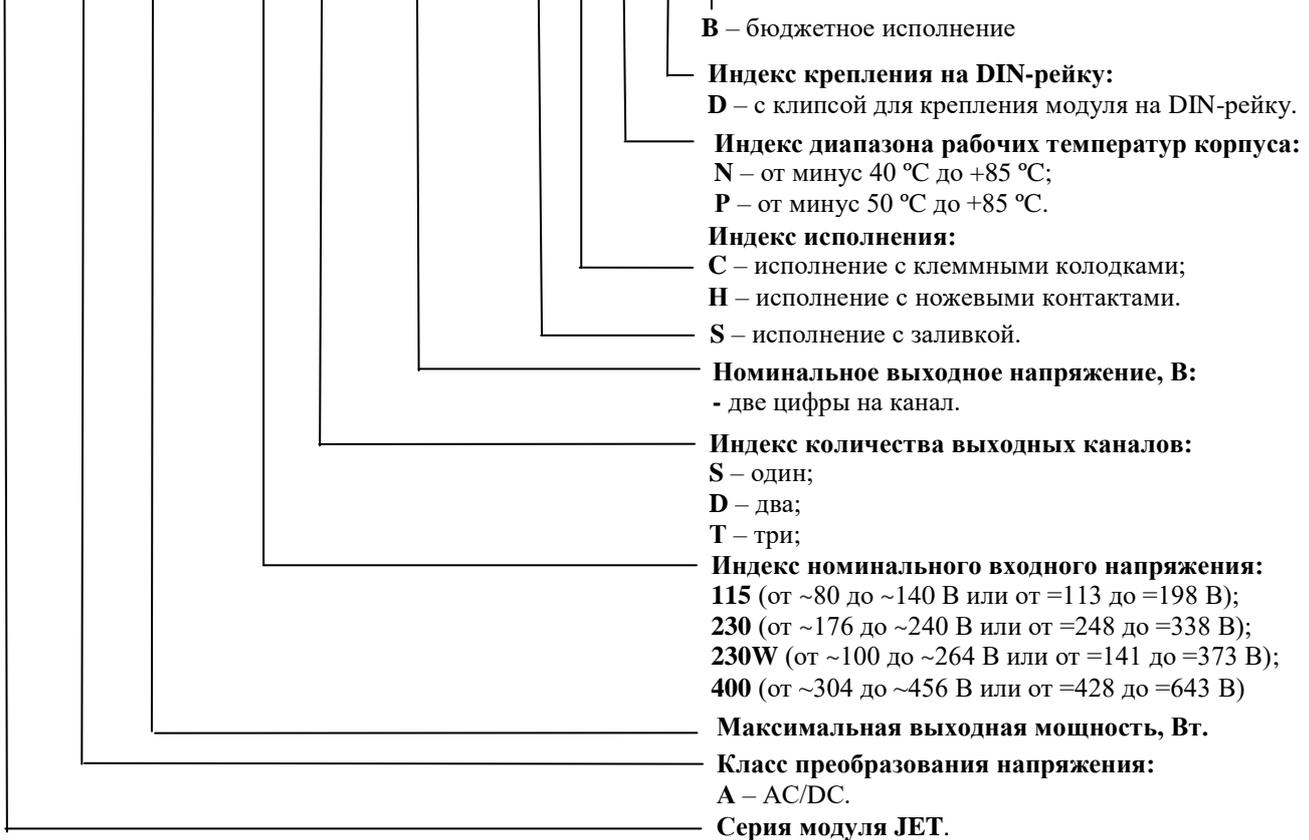
Рисунок 1 - Классификация и условное обозначение модулей
