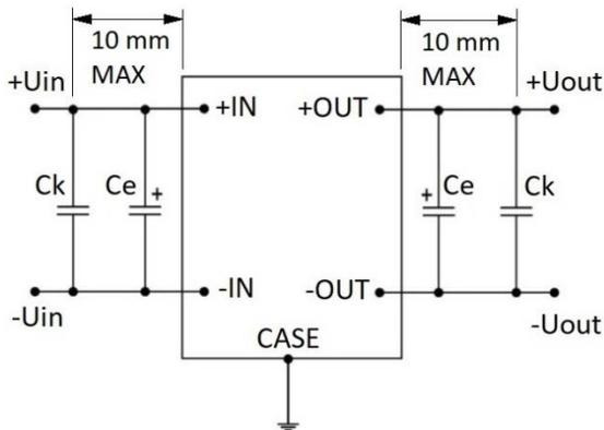
При любых применениях данных модулей в составе схемы подключения обязательно как минимум использование элементов типовой схемы, приведенной на рисунке.
