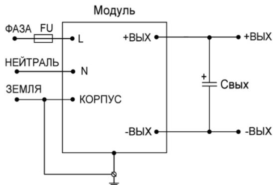
При любых применениях данных модулей в составе схемы подключения обязательно использование элементов типовой схемы, приведенной на рисунке.
