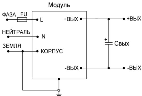
При любых применениях данных модулей в составе схемы подключения обязательно как минимум использование элементов типовой схемы, приведенной на рисунке.
