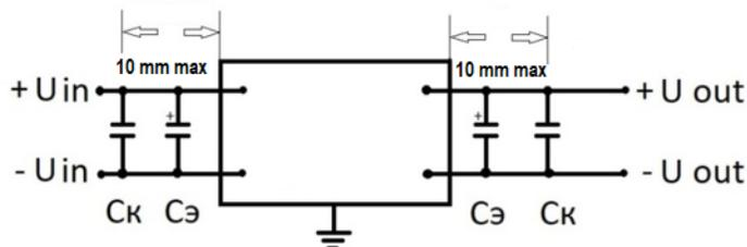
Конструкция модулей допускает их использование только при установке на печатную плату. Обязательно использование элементов типовой схемы, приведенной на рисунке. С<sub>к</sub> – керамические конденсаторы необходимого рабочего напряжения емкостью несколько мкФ, С<sub>э</sub> – электролитические конденсаторы
